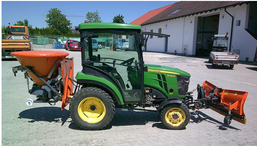
ISEKI-Traktor mit Schneepflug und Salzstreuer.
